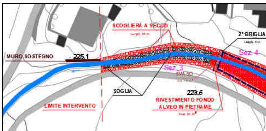
Schematizzazione degli interventi previsti a valle della seconda briglia visti in pianta.
