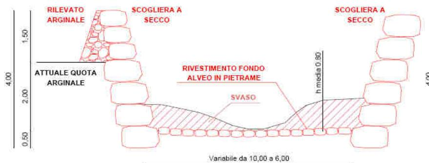
*Schematizzazione sezione tipo compresa tra le due briglie.*
