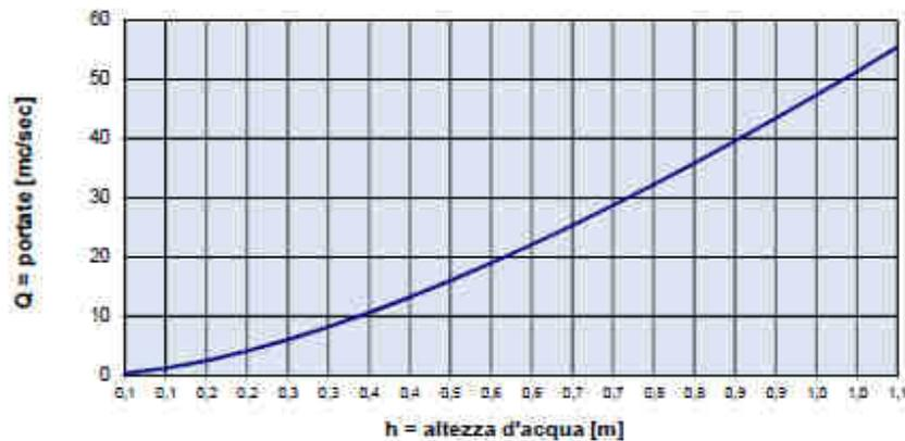
Dai risultati ottenuti si può osservare come la sezione libera smaltisce al massimo 55,41 m<sup>3</sup>/s, ossia un valore inferiore sia alla portata di massima piena centennale (64,02 m<sup>3</sup>/s) sia duecentennale (70,18 m<sup>3</sup>/s); pertanto la sezione in corrispondenza della Soglia S1 risulta **non verificata ed idraulicamente insufficiente**.
